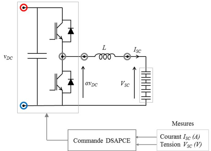
Fig.9 Convertisseur DC/DC pour la gestion de stockage.
