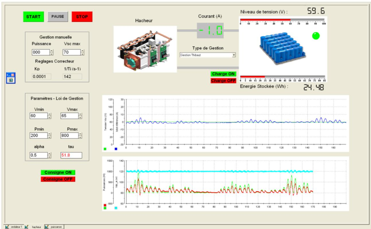
Fig.15 Illustration de l'interface de commande : Logiciel de Contrôle développé sous ControlDesk – fenêtre 2.
