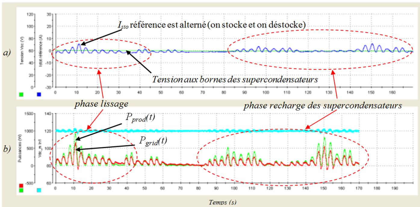
Fig.12 Exemple de mesure de puissances, en vert la puissance produite  $P_{prod}$ , en rouge la puissance réinjectée au réseau  $P_{grid}$  – émulation d’une production correspondant à un profil de puissance houlogénérée (correspondant aux conditions du profil de la figure 4) avec stockage d’énergie.
