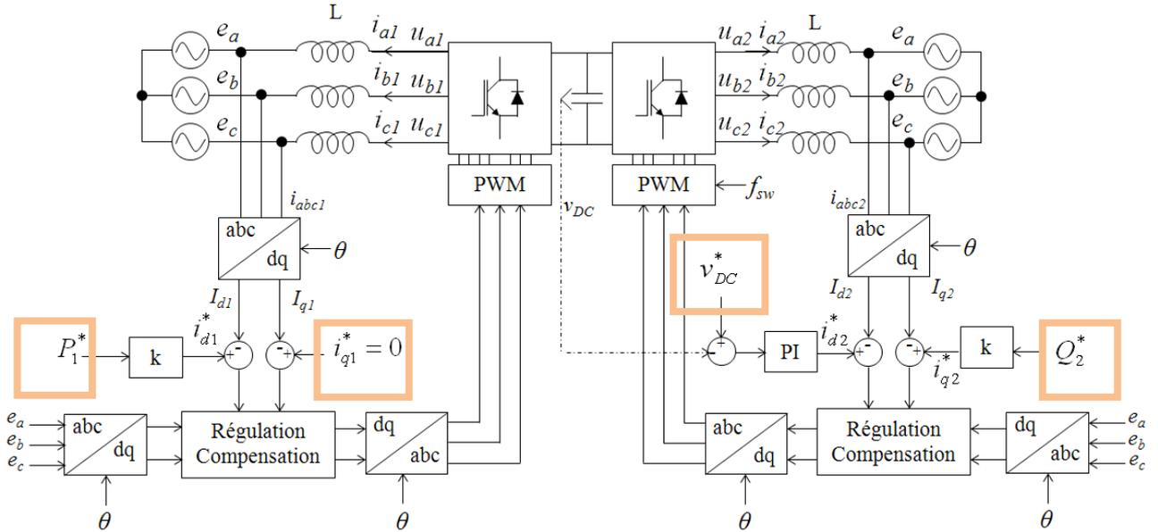
Fig.3 Schéma global de principe de commande de l'onduleur back-to-back connecté au réseau avec les deux ponts triphasés en convention générateur.
