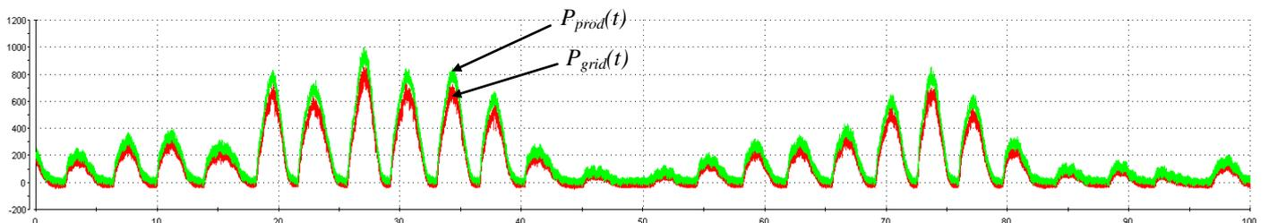
Fig.11 Exemple de mesure de puissances (sans lissage), en vert la puissance produite  $P_{prod}$ , en rouge la puissance réinjectée au réseau  $P_{grid}$  – émulation d'une production correspondant à un profil de puissance houlogénérée (correspondant aux conditions du profil de la figure 4).
