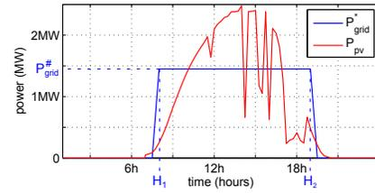
FIGURE 2 – Exemple de profil d’engagement et grandeurs associées :  $H_1$ ,  $H_2$  et  $P_{grid}^\# \cdot P_{peak} = 2.64 MW_p$
