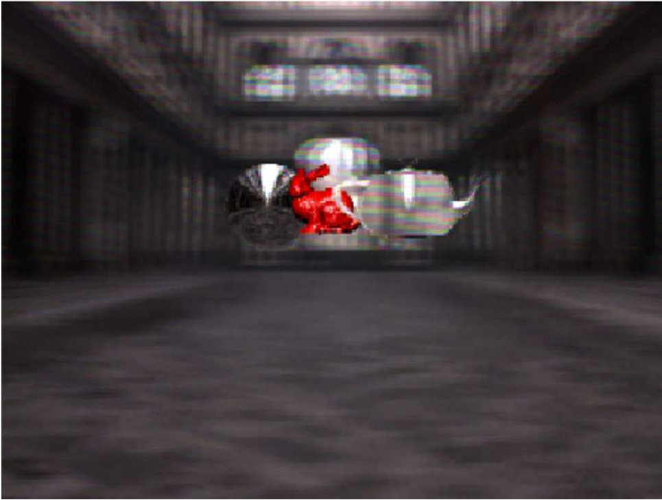
Figure 6: Exemple de composition de 4 images avec une repartition en biais des pixels (écran Philips).
