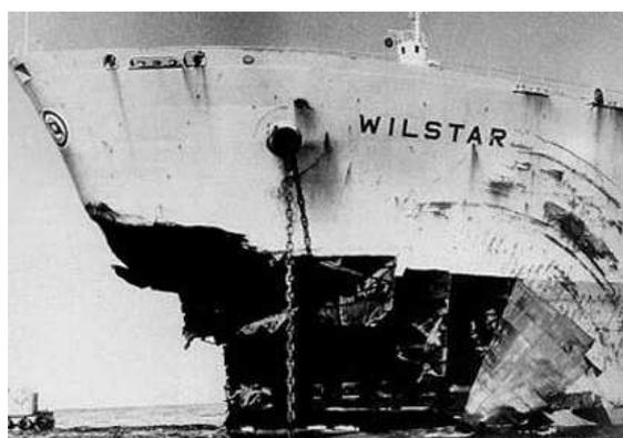
FIGURE 1.25 – Bateau endommagé par une “vague scélérate”.
